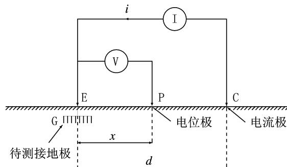
图 F.1 接线原理图
