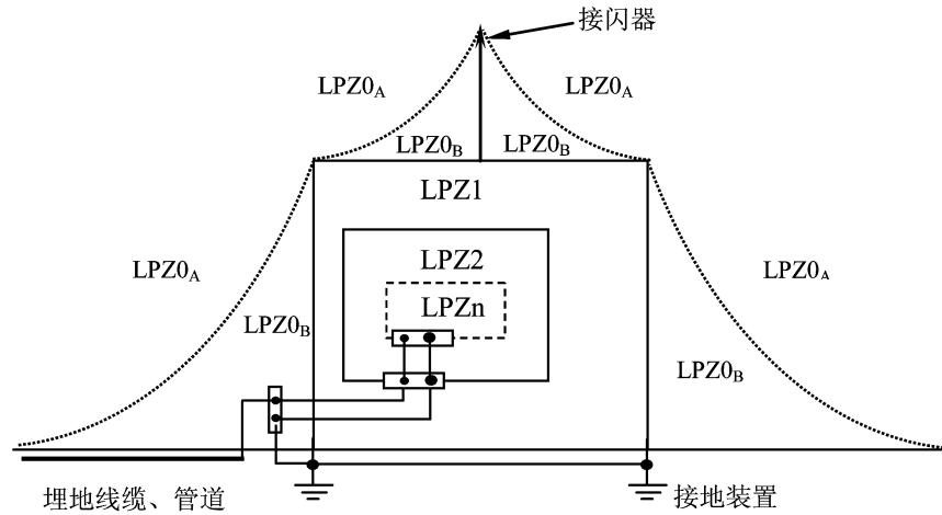
——在不同雷电防护区界面上的等电位接地端子板;
