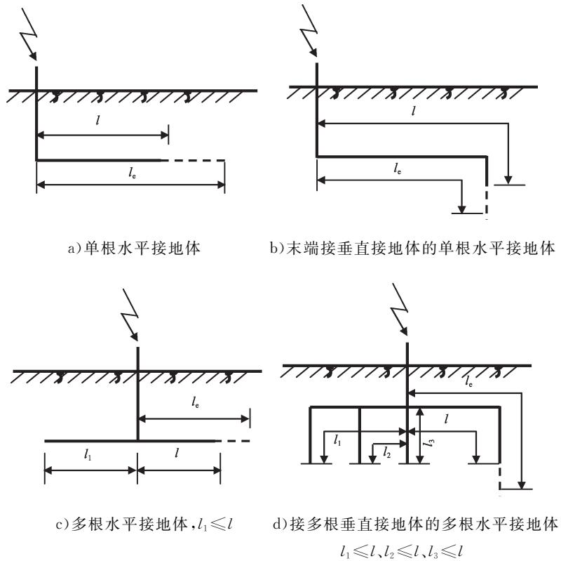
图 D.2 接地体有效长度的计量
