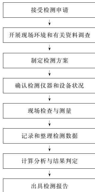
图 1 防雷装置检测工作程序
